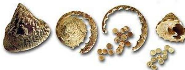
**Figure 8 : Découpage des coquilles de trocas pour le façonnage des boutons en nacre**
